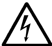
Signal de danger suivant DIN 4844-W8
