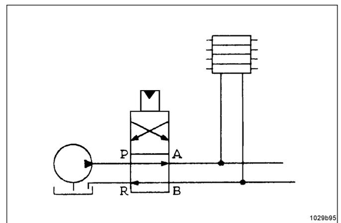
Abb. 2: MHY als Umsteuerung für Zweileitungsanlagen
