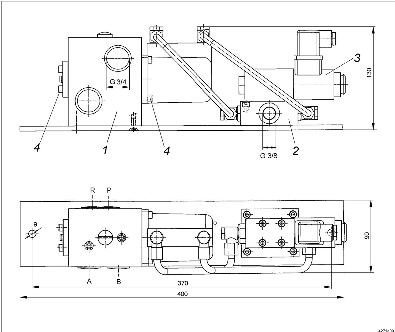
Abb.3: Aufbau der Umsteuerung MHY
