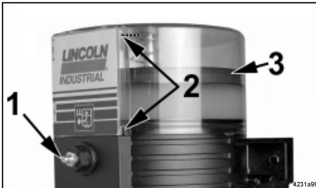
Abb. 31 - Behälter bis zur Max. Markierung auffüllen 1 - Befüllnippel 2 - Entlüftungsbohrungen 3 - Folgeplatte
