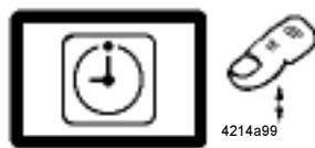
Abb. 24 - Quittieren einer blinkenden Störungsanzeige
