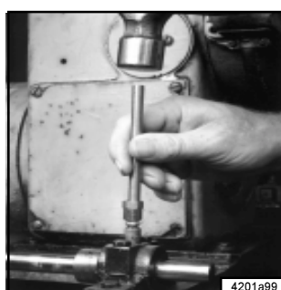
Abb. 6 - Montage des Zerk-Lock-Körpers mittels Treibwerkzeug
