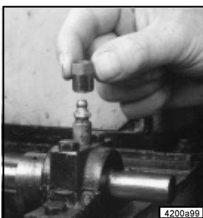
Abb. 5 - Zerk-Lock-Körper über den Befüllnippel stülpen
