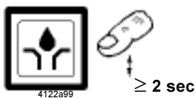
Abb. 31 - Taste zum Auslösen einer Zusatzschmierung
