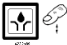
Abb. 21 - Taste zum Auslösen einer Zusatzschmierung
