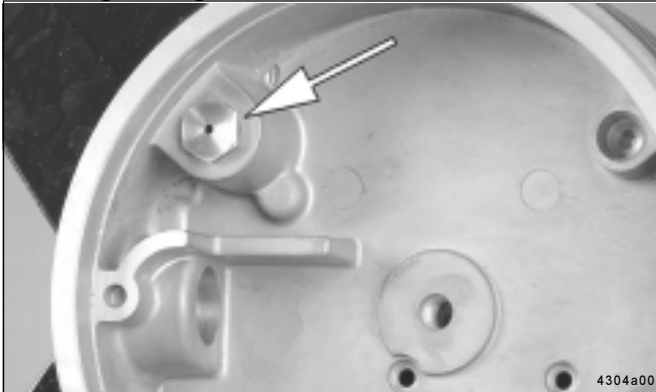
Abb. 16-Druckbegrenzungsventil (Patrone) im Gehäuse
