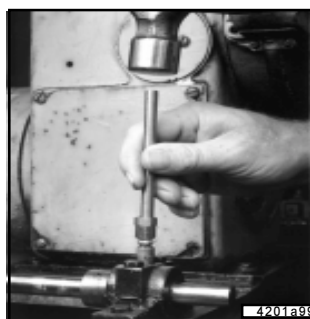
Abb. 6 - Montage des Zerk-Lock-Körpers mittels Treibwerkzeug
