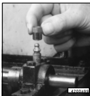
Abb. 5 - Zerk-Lock-Körper über den Befüllnippel stülpen
