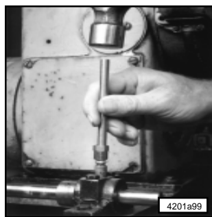
Fig. 6 – Montage du corps Zerk-Lock au moyen de l'outil spécial
