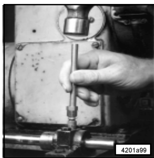
Abb. 6 - Montage des Zerk-Lock-Körpers mittels Treibwerkzeug
