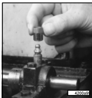
Abb. 5 - Zerk-Lock-Körper über den Befüllnippel stülpen
