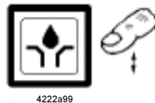
Fig. 20 - Touche de déclenchement d'un cycle de graissage supplémentaire
