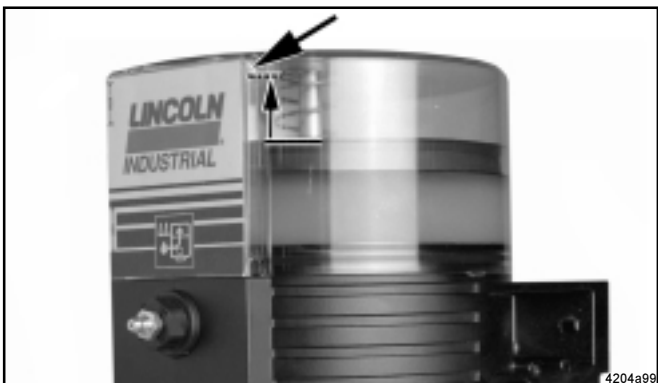
Fig. 11 - Trou d'aération dans le réservoir
