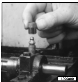
Fig. 6 - Poser le corps Zerk-Lock sur le mamelon de remplissage
