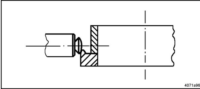
Fig. 9 - Installation incorrecte, le lubrifiant n'est pas refoulé
