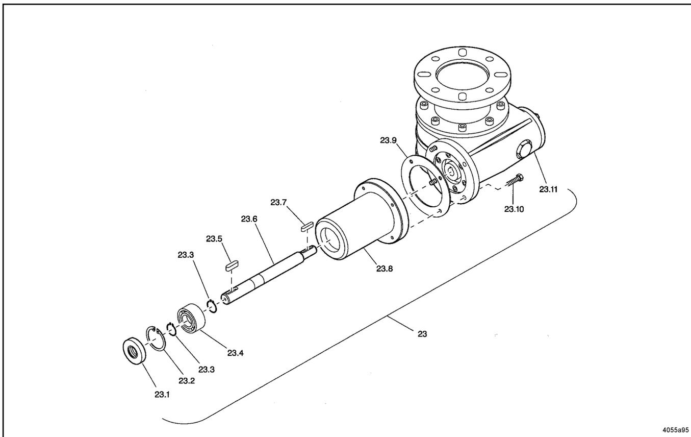
Fig. 13 - Pièces pour commande "bout d'arbre nu"
