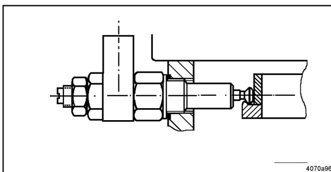
Fig. 8 - Élément de pompage installé correctement
