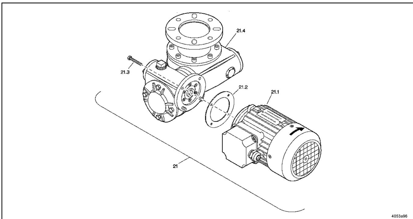
Fig. 15 - Pièces pour commande jumelée M 490 : 1
