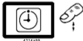
Fig. 24 – Acquitter un affichage de défaut clignotant
