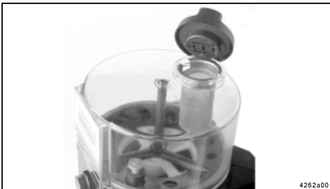
Fig. 30 – Remplir le réservoir jusqu'au repère max.
