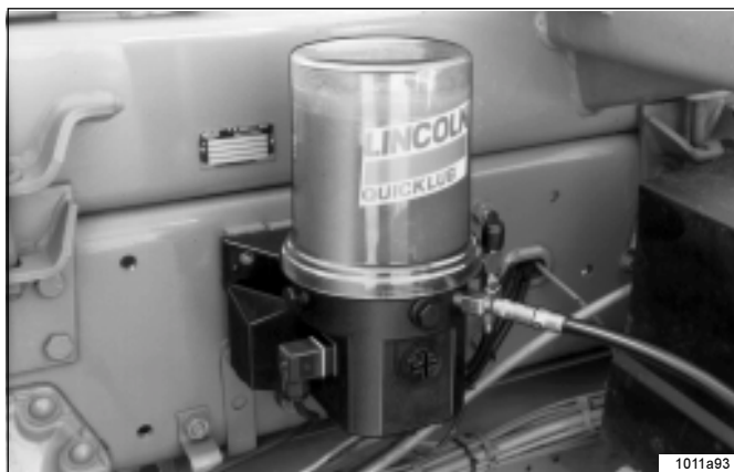
Abb. 21 - Behälter der Pumpe befüllen
