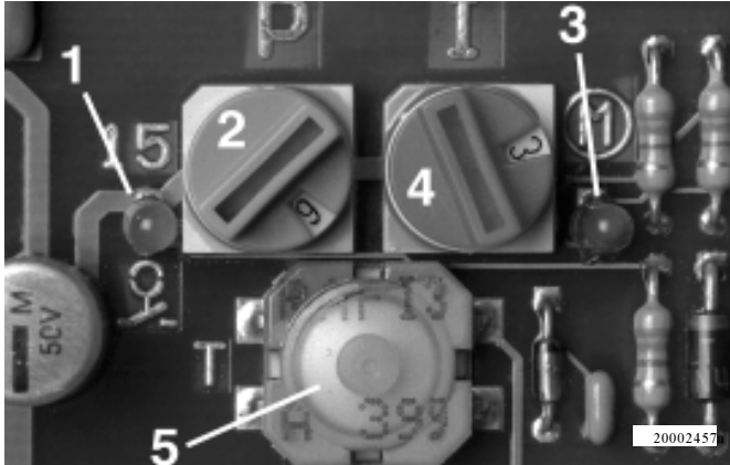
Abb. 28 - Leuchtdioden der Steuerplatine
