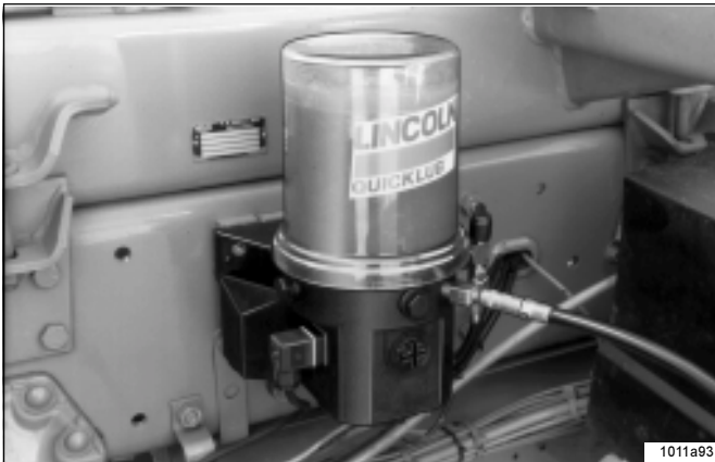
Abb. 29 - Behälter der Pumpe befüllen
