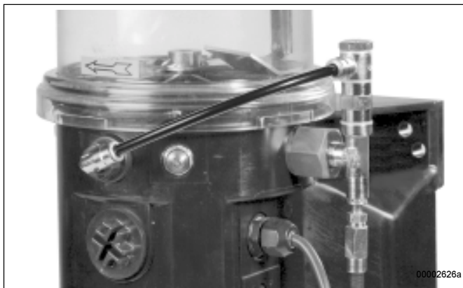
Abb. 13: - Druckbegrenzungsventil mit Fettrückführung
