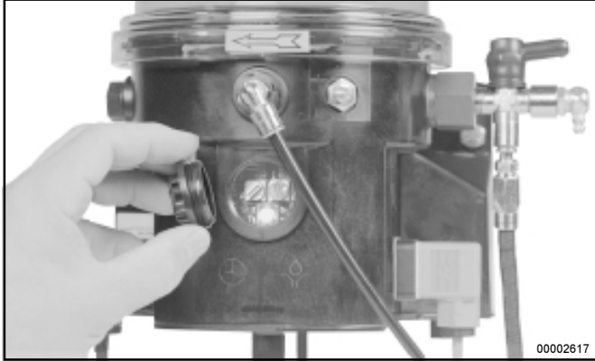
Fig. 11: - Le couvercle permettant d'accéder à la plaquette de circuits imprimés a été retiré
