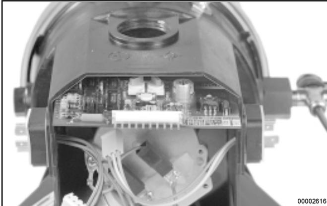
Fig. 4: Plaquette de circuits imprimés installée dans le boîtier
