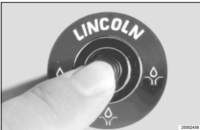
Fig. 13: Déclencher un cycle de graissage supplémentaire, seulement dans le cas de pompes équipées d'un bouton-poussoir lumineux
