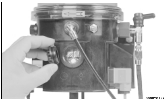
Abb. 17 - Verschlußdeckel zur Steuerplatine entfernt
