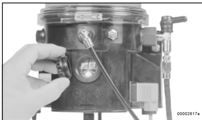
Abb. 13 - Verschlußdeckel zur Steuerplatine entfernt
