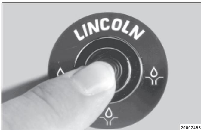
Abb. 13: - Zusatzschmierung auslösen, nur Pumpentyp mit Leuchtdrucktaster
