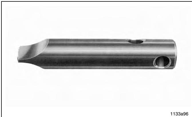
Abb. 123 Spezialschraubendreher für Verschluss-
