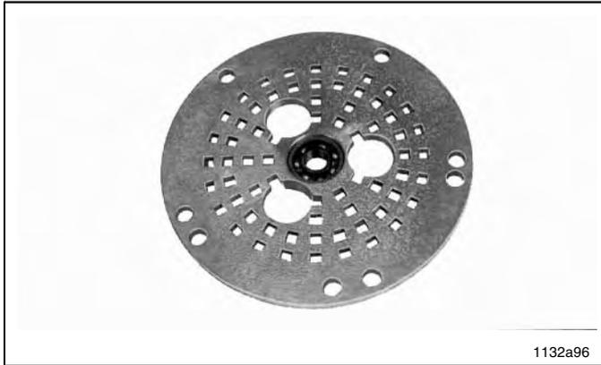
Abb. 121 Zentrierwerkzeug für Motormontage,
