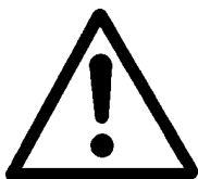
Signal de danger suivant DIN 4844-W9
