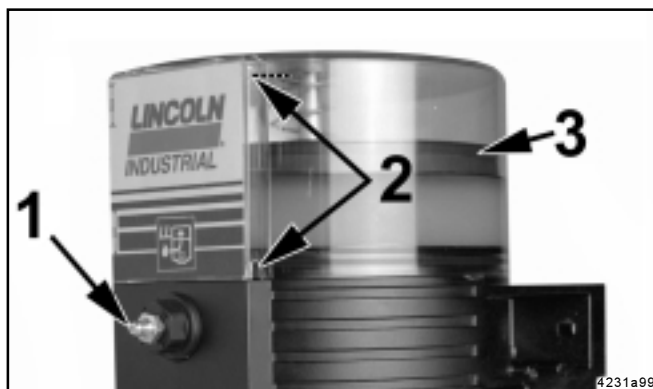
Fig. 18 - Remplir le réservoir jusqu'au repère max., QLS 301 1 - Mamelon de remplissage 3 - Plateau suiveur 2 - Trous d'aération
