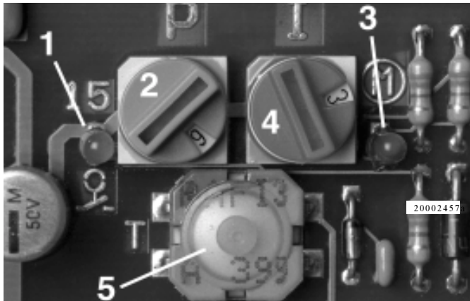
Fig. 27: Les LED de la plaquette de circuits imprimés
