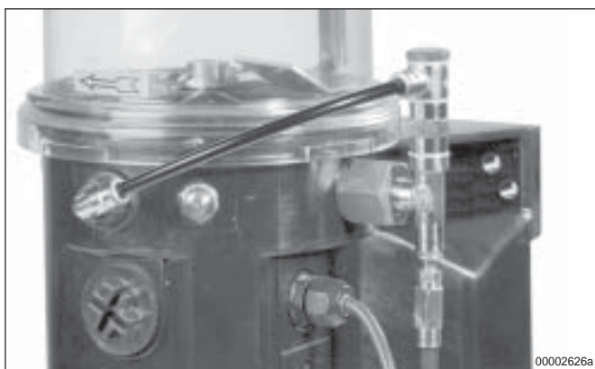
Abb. 13: - Druckbegrenzungsventil mit Fettrückführung
