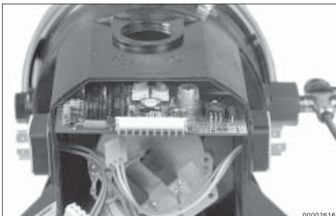
Abb. 16: - Steuerplatine im Gehäuse eingebaut
