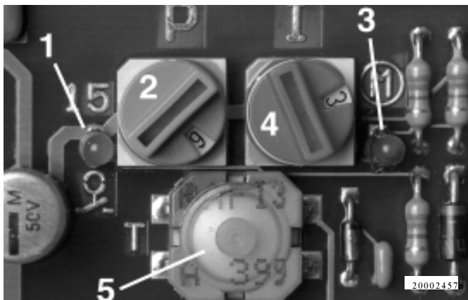
Abb. 29 - Leuchtdioden der Steuerplatine
