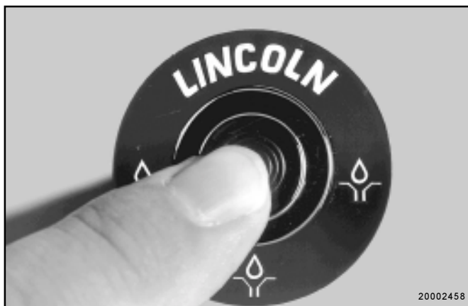
Abb. 21 - Externes Auslösen einer Zusatzschmierung
