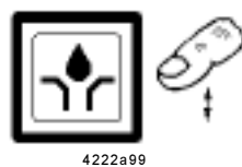
Abb. 25 - Taste zum Auslösen einer Zusatzschmierung
