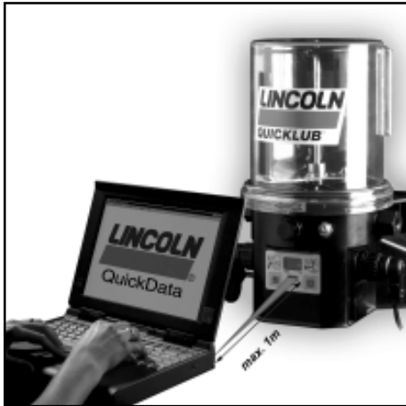
Abb.32 - Auslesen des Datenspeichers
