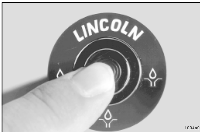
Abb. 12 - Zusatzschmierung vom Fahrerhaus oder vom Schaltschrank aus auslösen
