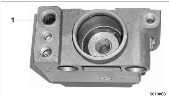
Abb. 10 Ölsieb reinigen
