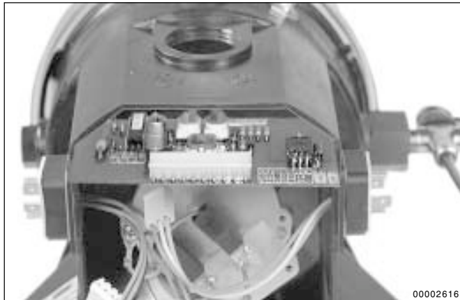
Abb. 3: - Steuerplatine im Gehäuse eingebaut
