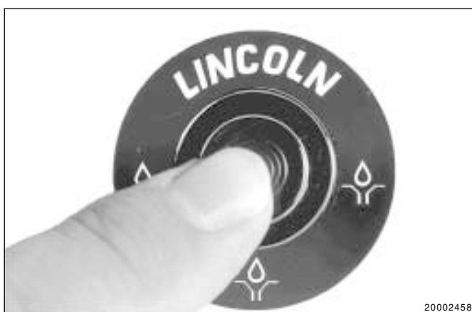
Abb. 10: - Zusatzschmierung auslösen, nur Pumpentyp mit Leuchtdrucktaster
