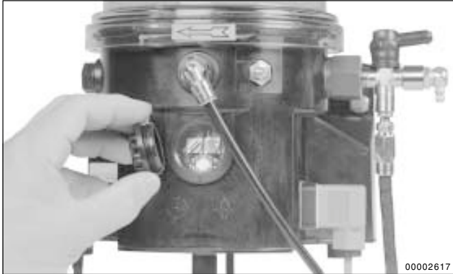
Abb. 6: - Verschlussdeckel zur Steuerplatine entfernt
