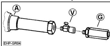
Entlüftungsventil (V) u. Rückschlagventil (G) mit dem Auslaß der Pumpe (A), wie abgebildet, verschrauben.
