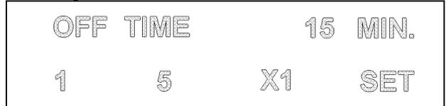
*Hinweis:* Das Text-Display zeigt in der ersten Zeile die eingestellte Pausenzeit von 15 MIN. an; diese Ziffer verändert sich jeweils mit Änderung der Pausenzeit. OK oder SET stehen für Taste F4, mit welcher die Einstellung abgeschlossen wird.
