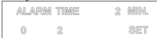
**Hinweis:** Das Text-Display zeigt in der ersten Zeile die eingestellte Monitorzeit von 2 MIN. an; diese Zahl verändert sich jeweils mit Änderung der Monitorzeit. OK oder SET stehen für Taste F4, mit welcher die Einstellung abgeschlossen wird.
