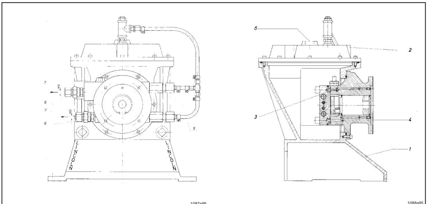
Abb. 2.4.2: Aufbau der Pumpe ZPU 09A
