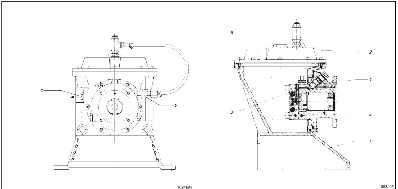
Abb. 2.4.1: Aufbau der Pumpe ZPU 09
