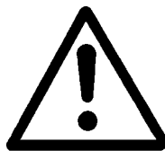
Signal de danger suivant DIN 4844-W9
