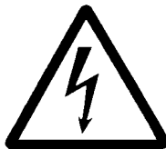
Signal de danger suivant DIN 4844-W8
