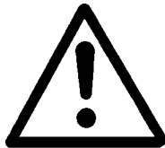
Signal de danger suivant DIN 4844-W9
