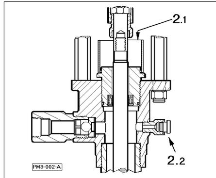
Desserrer la vis moletée de la soupape d'aération avec précaution (ne pas la retirer) de manière à ce que l'air puisse s'échapper. Ensuite, régler à nouveau la pression sur le régulateur de pression.
