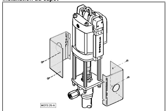
Assembler les deux éléments du capot autour des 4 tiges filetées et les visser avec les 4 vis jointes.
