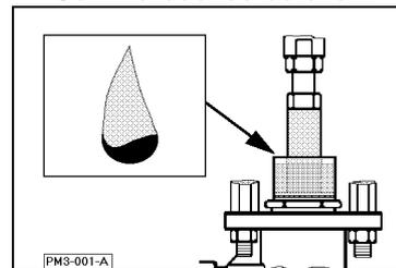
*Hinweis.* Bei Medien, welche an der Luft zum Antrocknen an der Kolbenstange neigen, ist die Schmierbüchse mit einem flüssigen Trennmittel / Trennöl zu befüllen.
