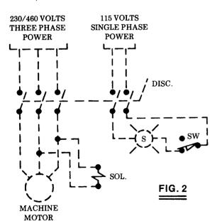
DISC. - INTERLOCKED DISCONNECT SWITCH
